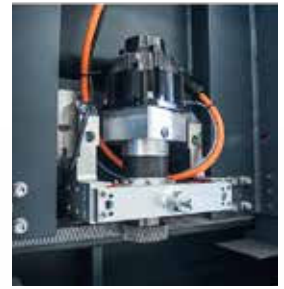
Accoppiamento pignone e cremagliera Pinion and rack connection
